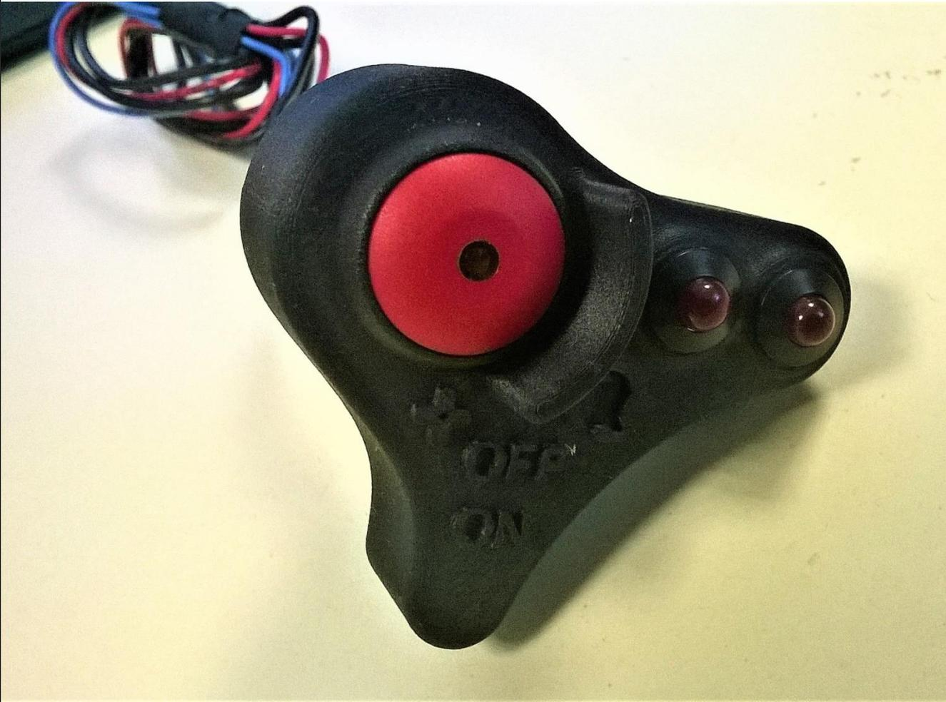
Pièce de test avec texte sortant et bouton et leds assemblés
