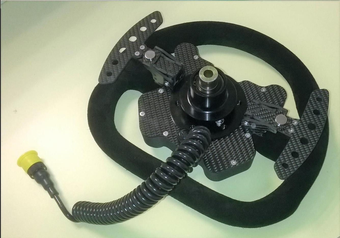
Volant Technomap assemblé et câblé
