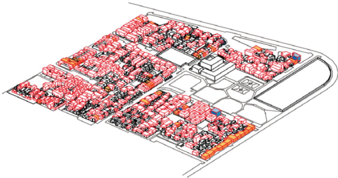
Plan du quartier PREVI en 2003 : on constate l'importance des transformations effectuées depuis plus de 20 ans. Le taux de transformation est relativement homogène sur tout le quartier. On perçoit la diversification formelle du bâti par les différentes hauteurs des extensions.
