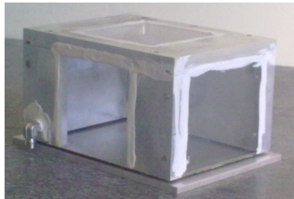
Figure 18 : Chambre de contrôle d'atmosphère et de pression
