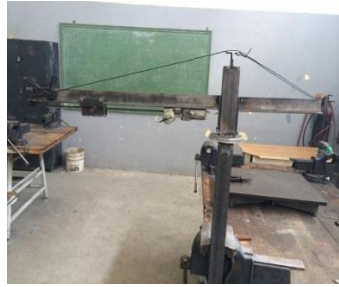
Figure 22: Assemblage mécanique de la grue
