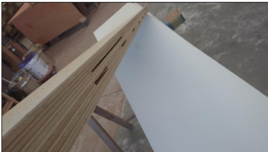
Perçage des lamellos dans la tablette.
