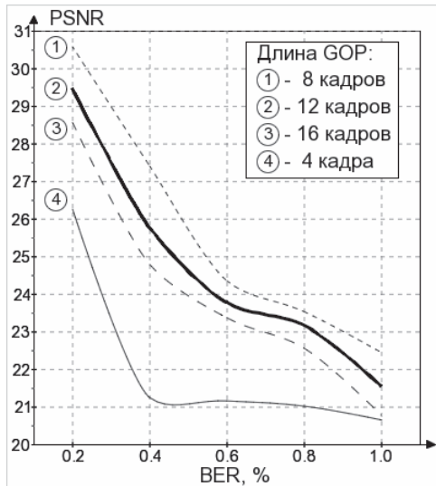
Рис. 10. График зависимости «сигнал/шум» PSNR от вероятности битовых ошибок BER
