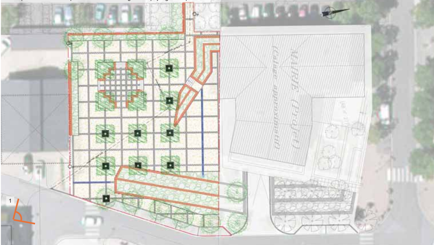
vue en plan - Phase DCE : plan masse des aménagements paysagers et qualitatifs
